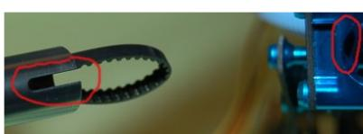
sicherzustellen, dass der Zahnriemen so gedreht ist, dass er sich um das Zahnräder im Chassis legen kann!
