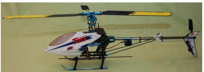
Der mechanisch-konstruktive Teil des Zusammenbaus ist mit diesem Schritt abgeschlossen. Die weiteren Schritte bestehen im Einbau und der Konfiguration der gesamten Elektronik, dem Justieren der Gestänge und dem Einrichten eines Heliprogramms am Sender.
