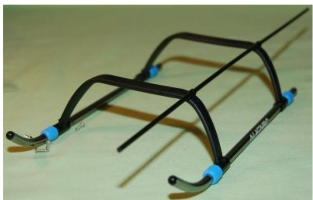
Dann schieben Sie die blauen Gummiringe auf. Drücken Sie diese bis an die Kufenbogen, dann schieben Sie den ersten Kufenhalter hinterher. Der zweite Kufenhalter wird nun soweit aufgeschoben, bis er dem Abstand entspricht, in dem er später unter das Chassi geschraubt werden kann. Zu guter Letzt werden dahinter wieder blaue Gummiringe aufgesteckt und das Antennenrörchen durch die Durchführungen geschoben. Das Landegestell ist nun fertig und kann unter das Chassi geschraubt werden.
