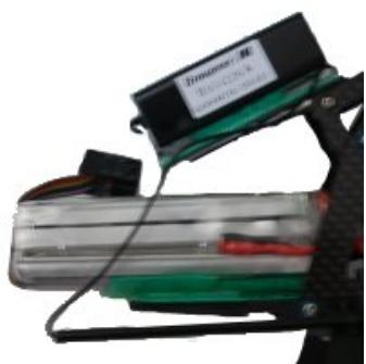
Auch der Empfänger lässt sich leicht mit Klettband auf der "Batteriehalterung" befestigen. Da die Kabellänge der Servos oft sehr knapp bemessen ist, sollte man den Empfänger so
