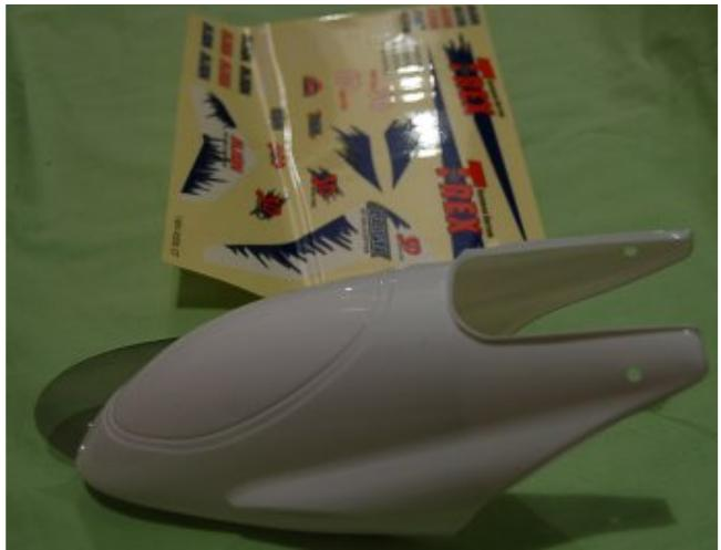
Es ist jedem selbst überlassen, wie er die Haube verschönert. In der HA wird angedeutet, man solle das Cockpitfenster aus dem weißen Kunststoff ausschneiden, genauso wie die Lüftungsschlitzte. Wer aber eine stabilere Haube bevorzugt, der kann darauf natürlich verzichten, doch muß er später darauf achten, daß Motor und Regler nicht zu heiß werden.
