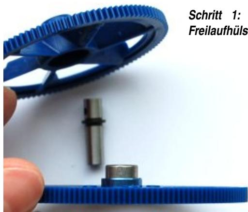
**Schritt 1: Einsetzen der Freilaufhülse**
