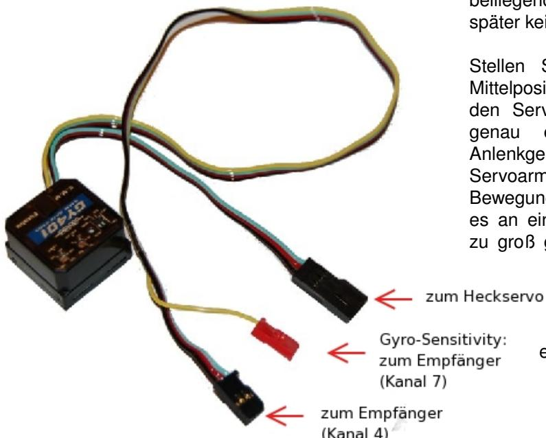
an den Steckern des GY401 abkneifen, damit diese in die Buchsen des Empfängers passen. Stellen Sie am Gyro den Schalter DS ("Digital Servo") auf Off.
